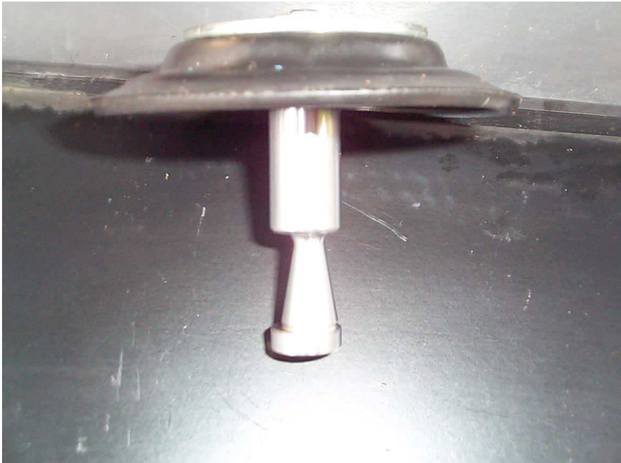
La membrane sortie de la pompe. On remarque l'excentricité du cône
